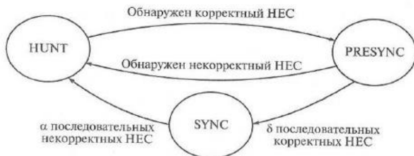
Рис. 5.26. Схема состояний автомата для обнаружения заголовка HEC
